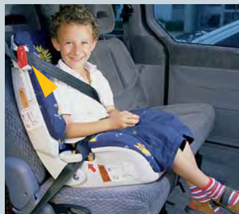
Schultergurtführung bei 3-Punkt-Gurtsystemen benutzen; dem Wachstum des Kindes anpassen.
