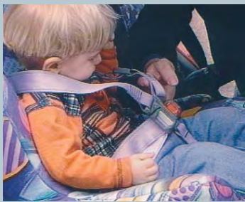
Falsch; zu locker!
